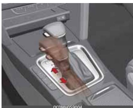
Kai automobilis stovi arba važiuoja, galite pasirinkti sportinį režimą per jung-dami pavarų svirtelę iš D (važiavimo) padėties į rankinį valdymą. Norédami vėl per jungti į D padėtį perjunkite pavarų svirtelę į pagrindinę kulisą.
