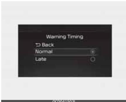
Kai variklio paleidimo jungiklis arba ENGINE START/STOP mygtukas yra ON padėtyje susidūrimo iš automobilio galo įspėjamosios sistemos įspėjimo laiko pateikimui pakeisti nustatymų meniu pasirinkite *Driver Assistance* → *Warning Timing* (pagalba vairuotojui → įspėjimo laikas).
