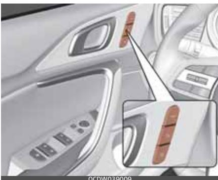
Vairuotojo sédynės padėties atmintinės sistema išsaugo ir prisimena sédynės padėtį vienu mygtuko paspaudimu. Išsaugojė norimą sédynės padėtį atmintinėje skirtingi vairuotojai gali atkurti jiems patogią sédynės padėtį. Jei akumulatorius buvo atjungtas padėties atmintis bus ištrinta, o sédynės padėtis turi būti išsaugota sistemoje.
