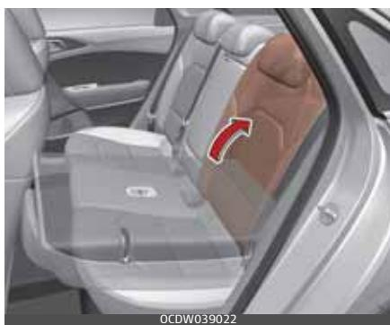
1. Norėdami pasinaudoti užpakaline sėdyne pakelkite ją ir paslinkite atgal. Paslinkite sėdynę atgal taip, kad ji užsirakintų. Įsitikinkite, kad ji gerai įsitvirtino. Gražinę atlošą į vertikalią padėtį ir stumdamai viršutinę atlošo dalį įsitikinkite, kad jis įsitvirtino savo padėtyje.
