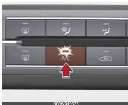
Paspausdami A/C mygtuką įjungsite oro kondicionavimo sistemą (užsi-degs indikatoriaus lemputė).
