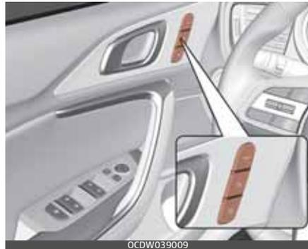
Vairuotojo sėdynės padėties atmintinės sistema išsaugo ir prisimena sėdynės padėtį vienu mygtuko paspaudimu. Išsaugoję norimą sėdynės padėtį atmintinėje skirtingi vairuotojai gali atkurti jiems patogią sėdynės padėtį. Jei akumuliatorius buvo atjungtas padėties atmintis bus ištrinta, o sėdynės padėtis turi būti išsaugota sistemoje.
