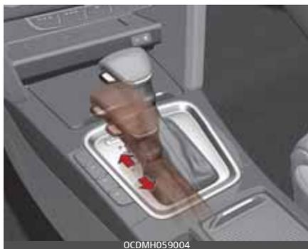
Kai automobilis stovi arba važiuoja, galite pasirinkti sportinį režimą perjungdami pavarų svirtelę iš D (važiavimo) padėties į rankinį valdymą. Norėdami vėl perjungti į D padėtį perjunkite pavarų svirtelę į pagrindinį kulisą.
