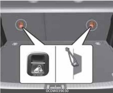
Vaiko apsaugos sistemos viršutinio diržo tvirtinimo įtaisai yra už galinių sėdynių atlošų.
