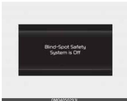
Jei variklis paleidžiamas iš naujo kai sistema išjungta, prietaisų skydelyje pasirodys pranešimas *Blind-Spot Safety System is Off*.
