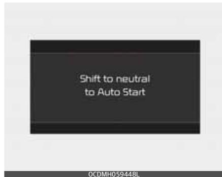
**Automatinė pavarų dėžė / dvigubos sankabos pavarų dėžė** – įjunkite pavarų perjungimo svirtelę į P (stovėjimo) padėtį. Iki galo paspauskite stabdžių pedalą. Variklį galite paleisti, kai pavarų svirtelė yra N (neutralioje) padėtyje.
