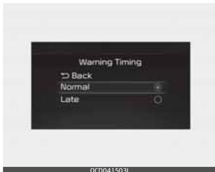
Kai variklio jungiklis arba ENGINE START/STOP mygtukas yra ON padėtyje, LCD ekrane arba informacijos ir pramogų sistemoje pasirinkite *User Settings* (naudotojo nustatymai) → *Driver Assistance* (pagalba vairuotojui) → *Warning Timing* (įspėjimo laikas) jei norite pakeisti susidūrimo iš priekio išvengimo pagalbos sistemos įspėjimo pateikimo laiką.
